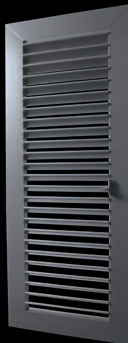
TYP A7 Schwenkbare, innenliegende Lamellen 50 x 10 mm, die mit Dreholive oder Hebel verstellt werden können. Schwenkbare, überstehende Lamellen 98 x 13 mm, mit Schubstange bedienbar.
