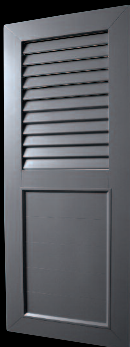
TYP A4 Kombination aus wahlweise innenliegenden oder überstehenden Lamellen mit Füllungspaneel 100 x 15 mm oder glattem Blech 2,5 mm stark.
