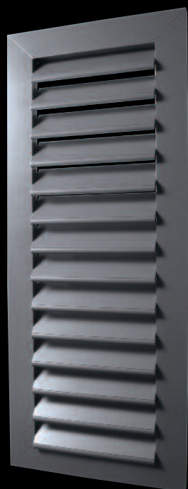
TYP A2 Überstehende Lamellen 98 x 13 mm, Rahmen 80,2 x 32,2 mm, Kämpfer auf Wunsch.
